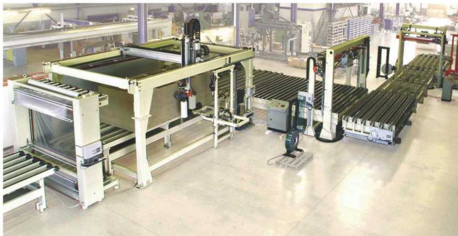
Beispiel einer Verpackungsanlage für Rohspanplatten
